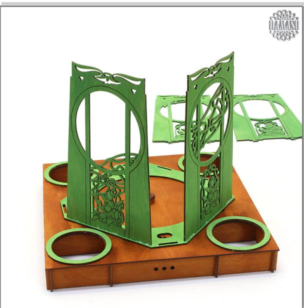
Lassen Sie die erste Seite kurz antrocknen und leimen Sie dann die Seite 2 in der gleichen Art und Weise auf. Dazu lösen Sie die Verhakung der ersten Seite mit einer leichten Drehung im Uhrzeigersinn, setzen die zweite Seite ein und verhaken beide Seiten wieder mit einer leichten Drehung gegen den Uhrzeigersinn.
