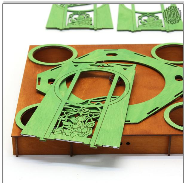
Nun wird das Seitenteil mit der Nummer 1 auf die Bodenplatte der Etage geleimt. Dazu wird nur auf die Stirnseiten der Unterkante etwas Leim gegeben. Die Zapfen müssen völlig leimfrei sein.
