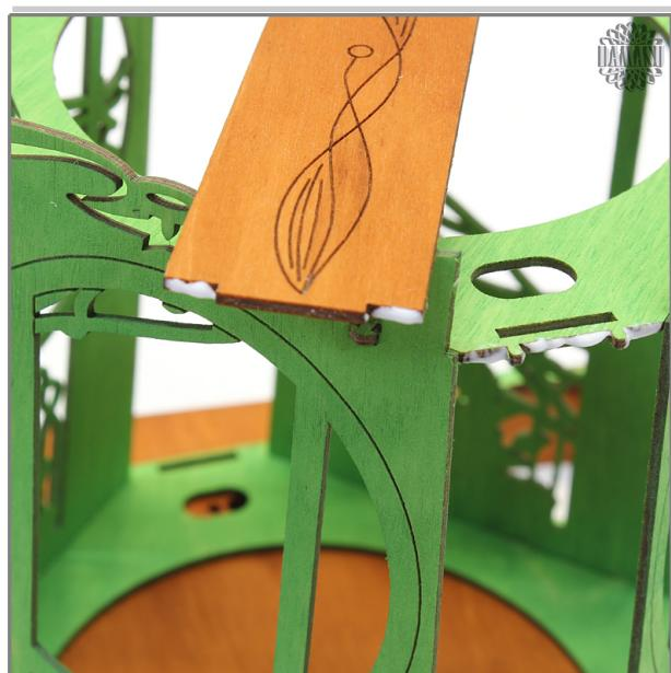
Nun werden die schmalen Seitenwände angeleimt. Geben Sie etwas Leim an die Kante und die Zapfen der Deckplatte und an die Unterseite der Seitenwand. Achten Sie wieder darauf, dass der Zapfen der Seitenwand selbst nicht verleimt wird. Es könnte sonst eine Leimverbindung zum Sockel entstehen.
